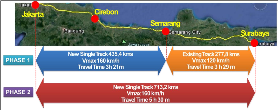
Gambar 4.30 Pembangunan Rel Kereta Semi Cepat Jakarta – Surabaya
